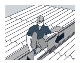
Lorsque l'assemblage est réalisé sur la toiture, un platelage annexe est nécessaire.
