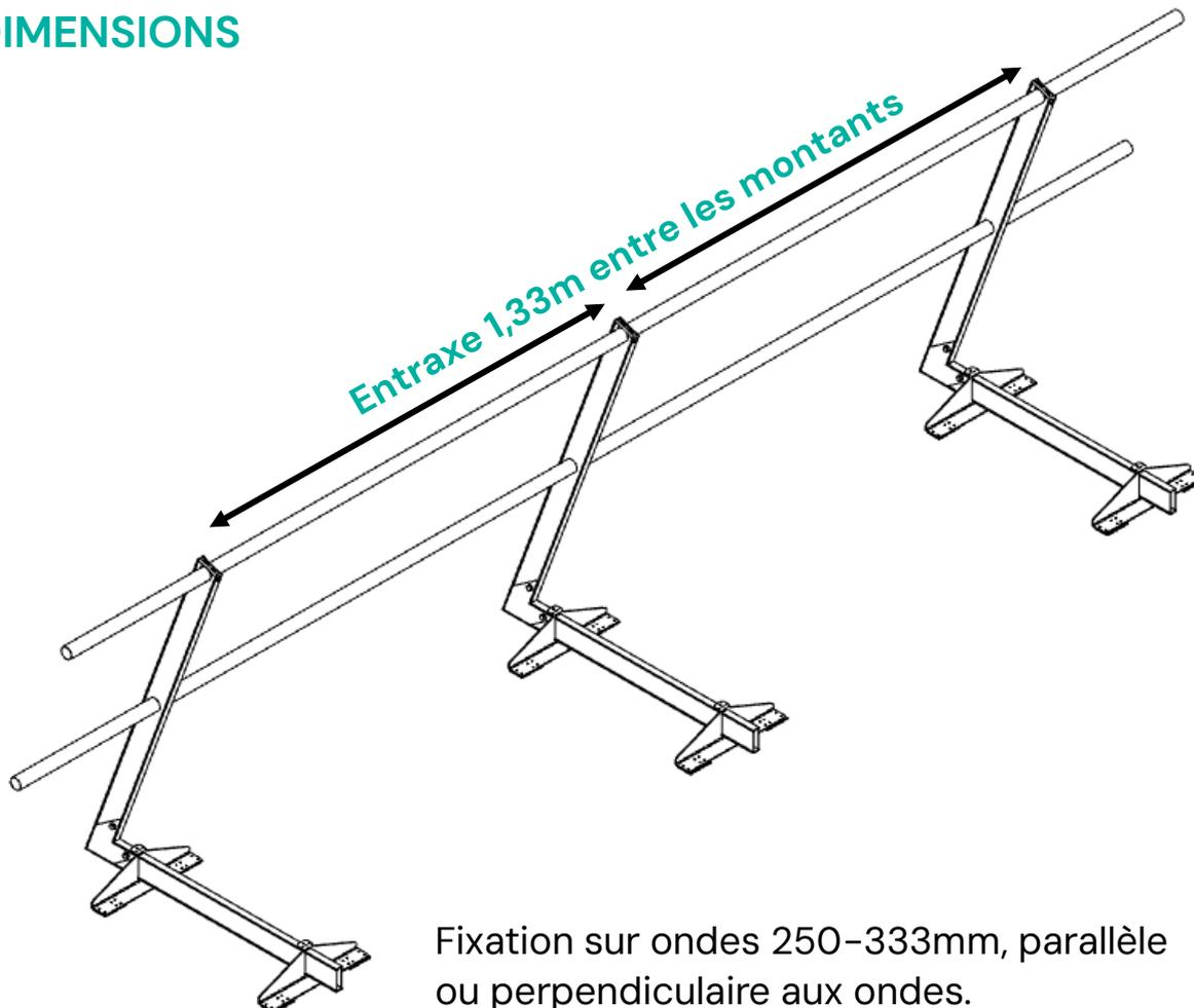
Fixation sur ondes 250-333mm, parallèle ou perpendiculaire aux ondes.
